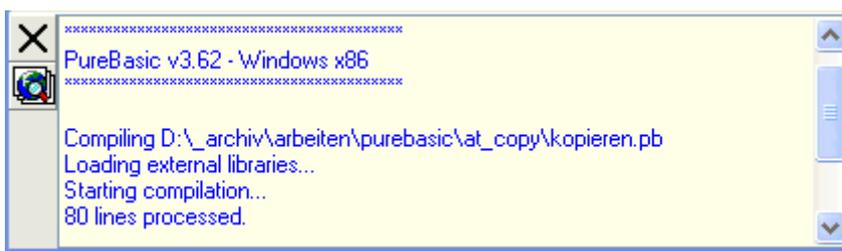
Hier werden weitere Informationen zu z.B. Fehlerart oder Fehlerstelle ausgegeben. Mit dem oberen Icon wird die Ausgabekonsole geschlossen und mit dem unteren wird der Inhalt der Ausgabekonsole in der Vorschau angezeigt.
